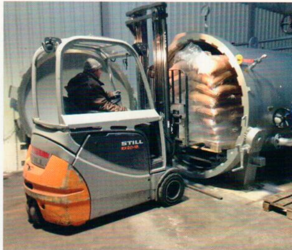
Seit Januar hat das Lagerhaus Harburg eine Druckentwesungsanlage in Betrieb.
